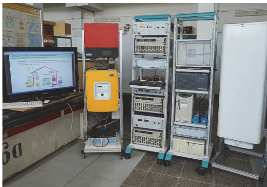
Abbildung 3: AC- und DC-gekoppelte Topologie des Experimentiersystems zur praxisnahen Untersuchung von Multispeicher-Hybridsystemen zur erweiterten Eigenverbrauchsoptimierung von Solarstrom (mit Ausgleich im Tages-/ Jahresbereich und intelligentes „peak shaving“) [5]
