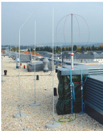
Abbildung 1: Messsystem zur Erfassung des Blitzstromes
