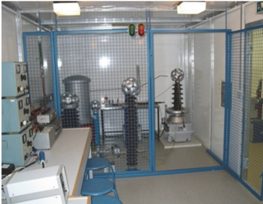
Abbildung: Geschirmte Messkabine zur Teilentladungs- und Verlustfaktormessung
